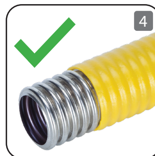
Zorg dat vijf ribbels intact en onbeschadigd zijn voor montage.
