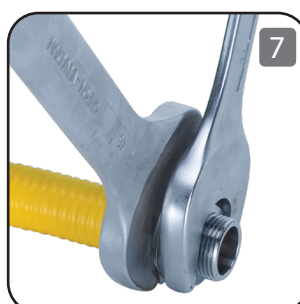
Monteer met een dubbele steeksleutel.
