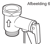
Drukontlastingsgat om de afvoerleiding aan te sluiten
